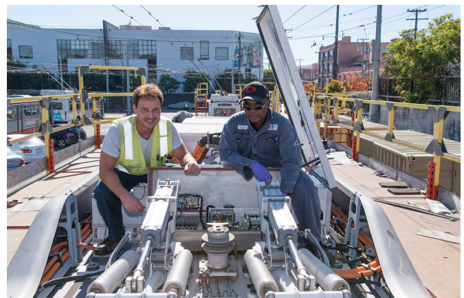
Trabajadores haciendo reparaciones a la parte superior de los vehículos en el exterior debido a los techos bajos en Potrero Yard
